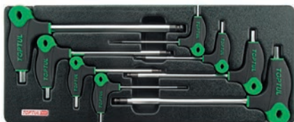
Module de clés 6 pans en forme I €10 8 pièces AGCD0214-1027 · Clés mâles 6 pans à tête sphérique double entrée, type L · ⊕ + ⊖ 2 x 140 · 2,5 x 140 · 3 x 140 · 4 x 140 · 5 x 203 · 6 x 203 · 8 x 265 · 10 x 265 mm REF : TT-GAAT0811
